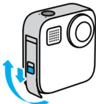
2. Con la cámara apagada, inserta la tarjeta SD en la ranura para la tarjeta con la etiqueta orientada hacia el compartimento de la batería.
